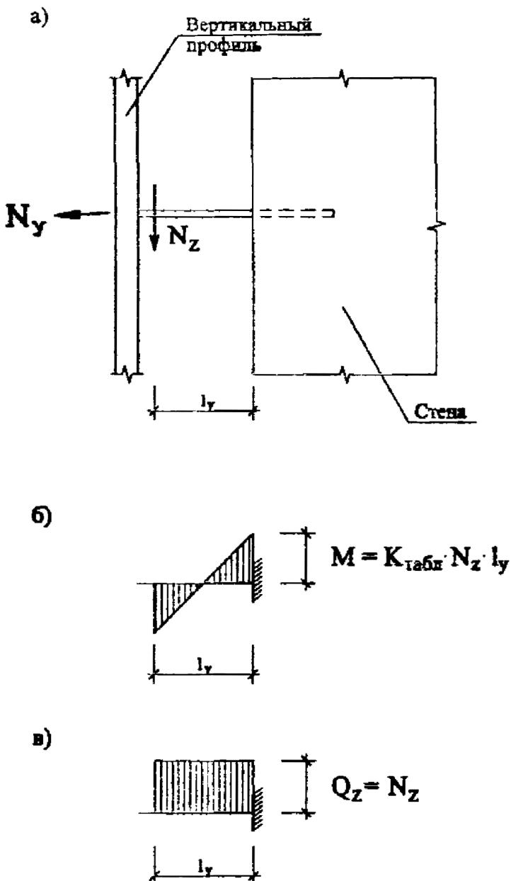
Рис. 6.2. Расчетная схема анкера-шпильки
