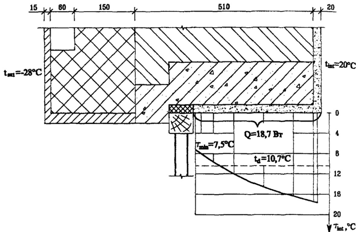
Рис. 1. Температурные поля у оконного откоса, вариант 1
