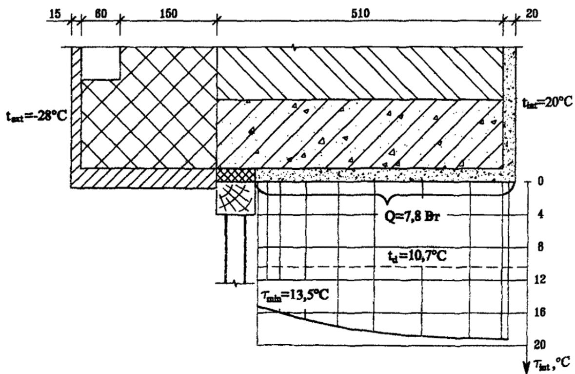
Рис. 2. Температурные поля у оконного откоса, вариант 2
