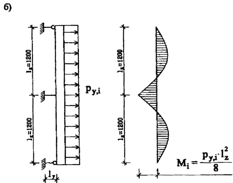
Рис. 6.3. Расчетные схемы вертикального профиля
