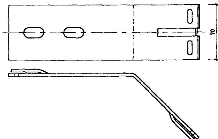
Рис. 3.6. Система "Интерал", кронштейны
