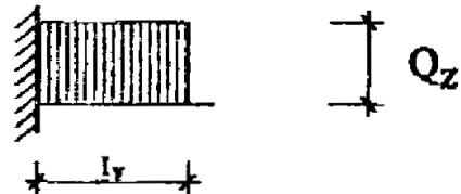
Рис. 6.5. Расчетная схема кронштейна
