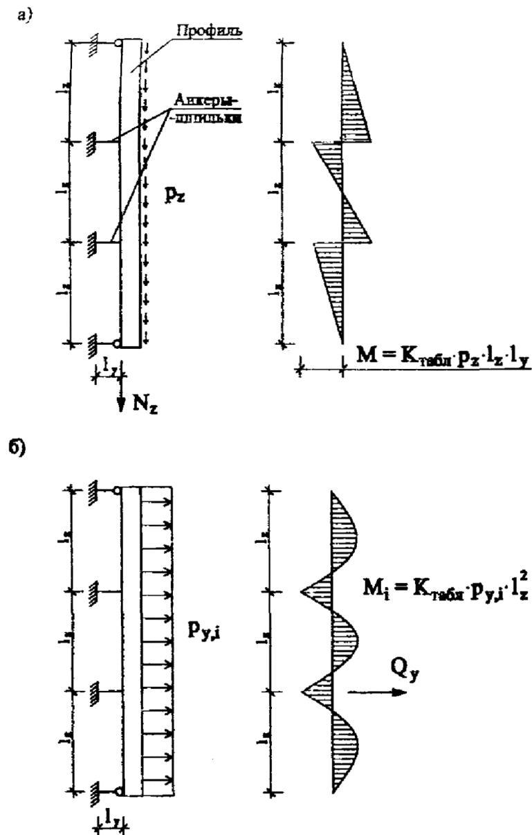
Рис. 6.1. Расчетные схемы вертикального профиля
