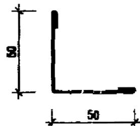
Рис. 3.7. Система "Интерал", вертикальные профили (поперечное сечение)
