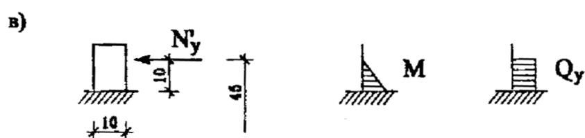
Рис. 6.4. Расчетная схема фланжка
