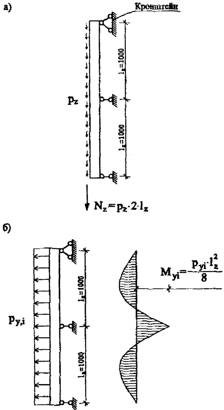
Рис. 6.6. Расчетные схемы вертикального профиля
