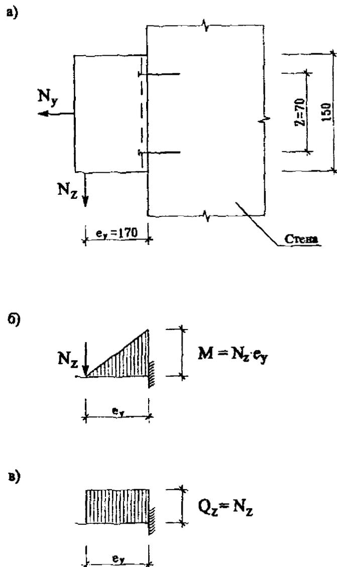
Рис. 6.7. Расчетная схема несущего кронштейна
